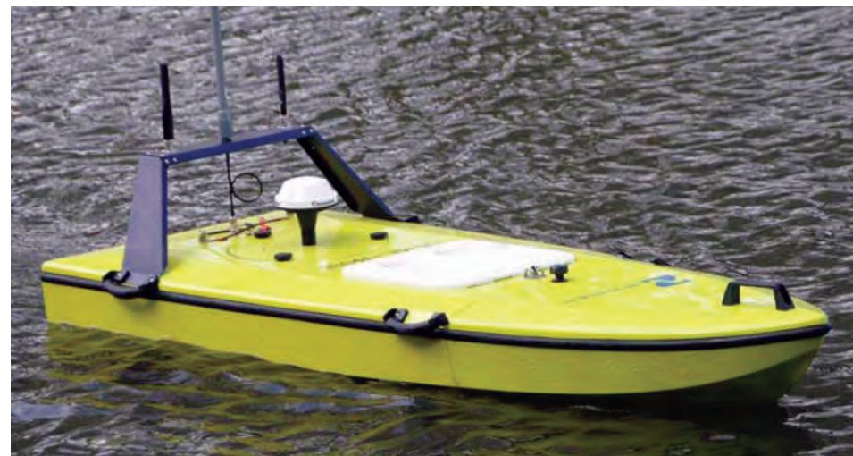
Дистанционно управляема лодка ARCboat за измерване на скорости на течението, пробонабиране и батометрични изследвания
